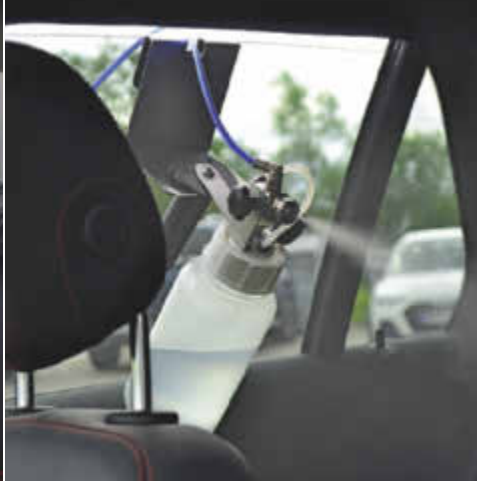
Bei Biocleen erfolgt die Desinfektion durch Innenraumvernebelung einer Desinfektionslösung.
